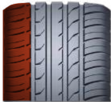
Äußeres Schulter-Block-Profil für perfekten Geradeauslauf und gutes Kurvenhandling
